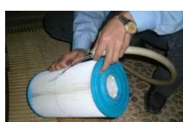
4. Tvätta med filterrengöring. Låt torka
